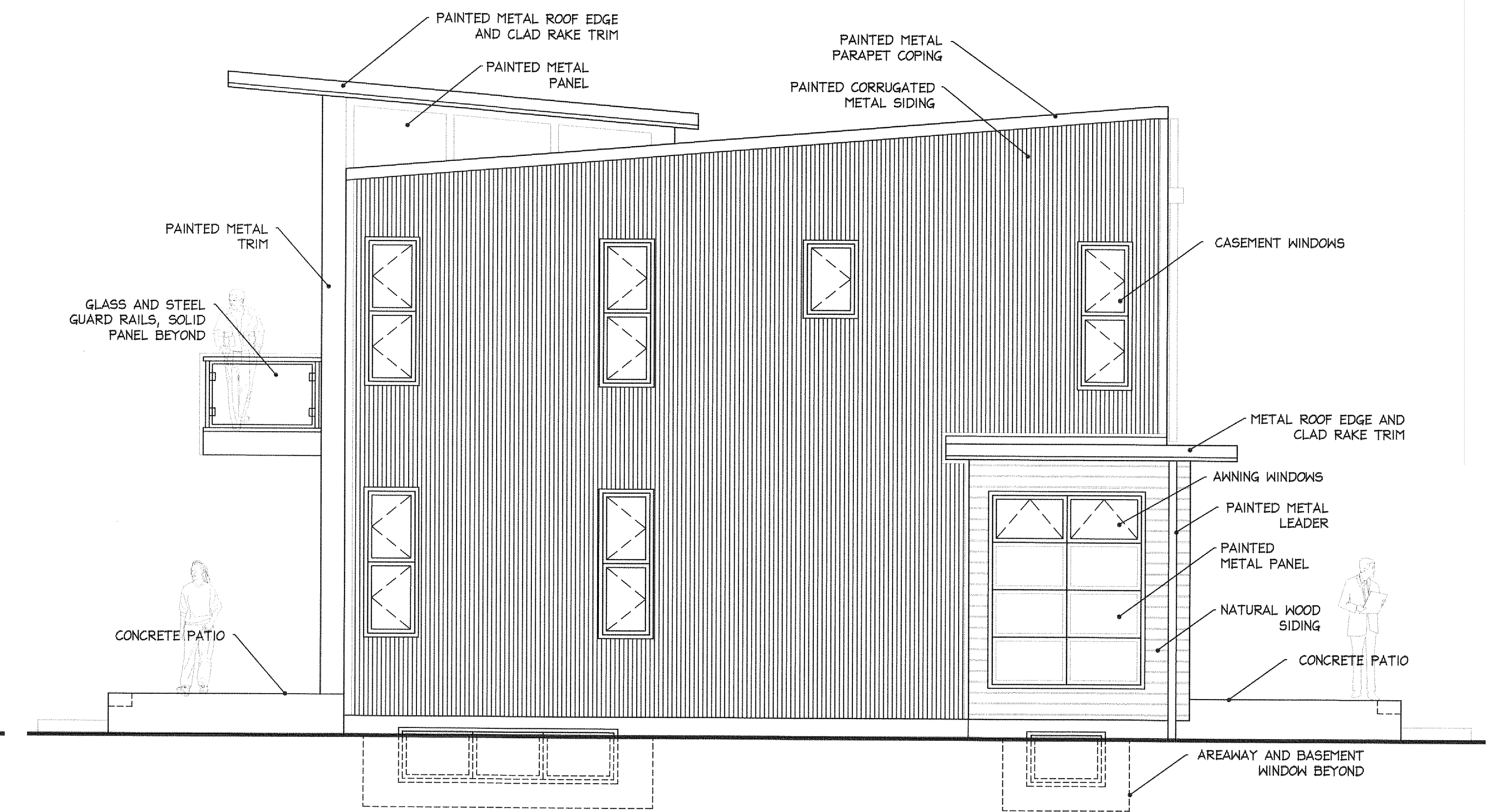
BUILDINGS D1 & D2 RIGHT ELEVATION
